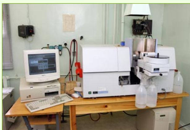
Атомно-адсорбционный спектрофотометр AA Analyst 800
