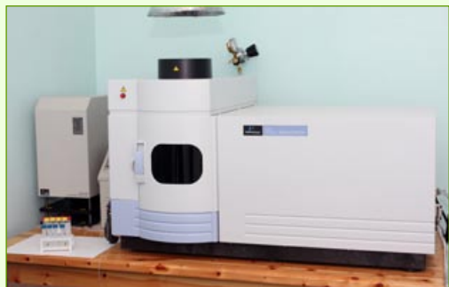
Прибор OPTIMA 2100 DV для оптической спектрометрии с индуктивно-связанной плазмой (ICP-EOS)
